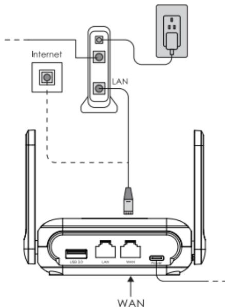
3. Connettersi al dispositivo tramite connessione wireless o cablata.
