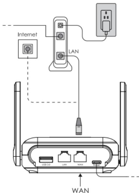
3. Conéctate al dispositivo a través de una conexión inalámbrica o por cable.
