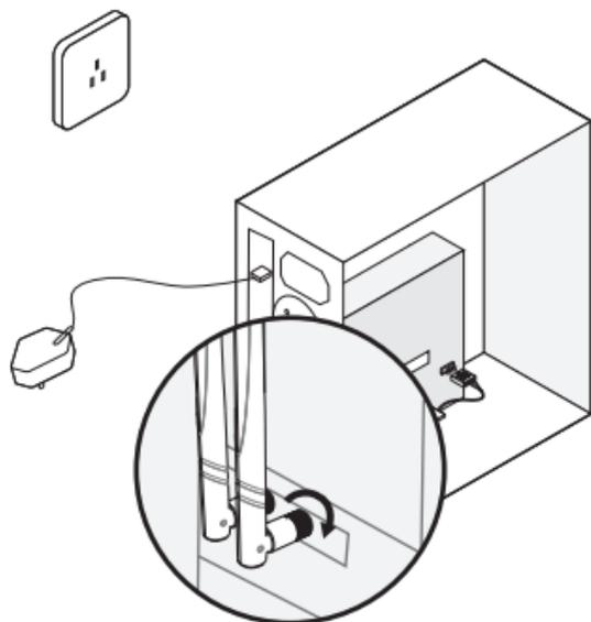
6. Infine, reinstalla il pannello del case del PC e poi sarai pronto per installare il driver.
